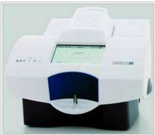
Серия NPT7 – портативный анализатор КЩС, газов и оксиметрии крови, модель 2005 года.
